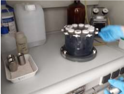
Figura A | Filtrador automàtic en el que es va realitzar la tinció i filtració de les mostres.
