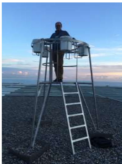
Figura 2 | Recollida de partícules atmosfèriques al terrat de l'Institut de Ciències del Mar de Barcelona. Imatge de http://anima.icm.csic.es/gallery/ .
