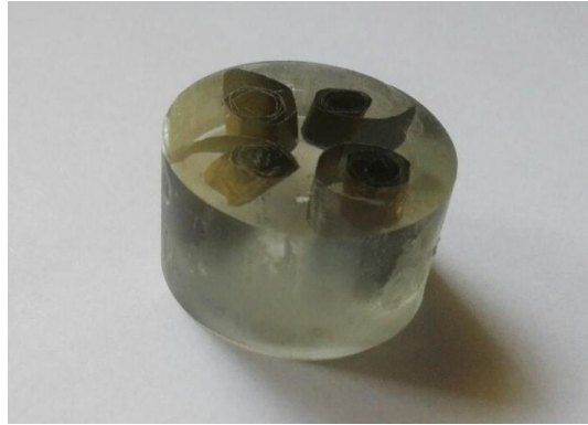
Figura 3.12. Cuatro cintas de PLA/Mg embutidas perpendicularmente en resina epoxi para estudiar su corte transversal.
