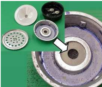
Despiece de un micrófono de carbón y detalle del compartimento que contiene los granos de carbón
