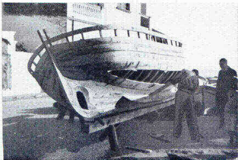
Colocación de las tablas del forro en una barca de 3.5 T. m.
