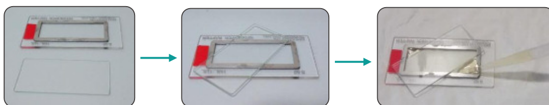
Figura 11. Muntatge de la cambra Sedgewick-Rafter i col·locació de la mostra.
