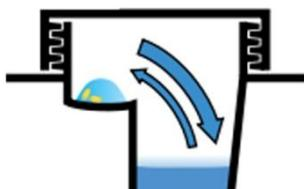
Figura 59. Esquema de la gota asseguda en el mètode de difusió de vapor.
