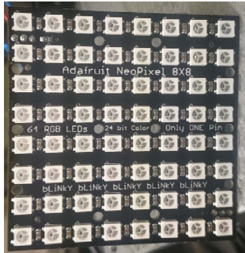
Fig. 1. Matriz 8x8 de LEDs RGB de alta potencia, que será utilizada como patrón para la caracterización de ILMDs.
