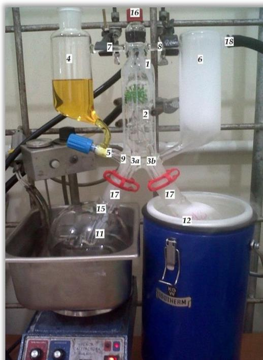
**Figura 2.** Fotografía tomada al equipo para extracción de aroma asistida por disolvente (SAFE), en la extracción realizada a la guayaba agria.
