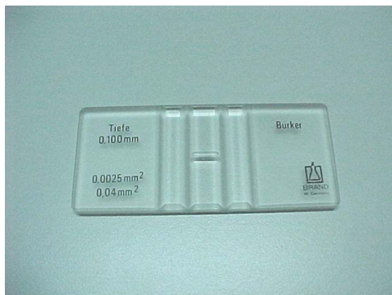
Figura 4. Cámara de Bürker para medida de la concentración espermática.
