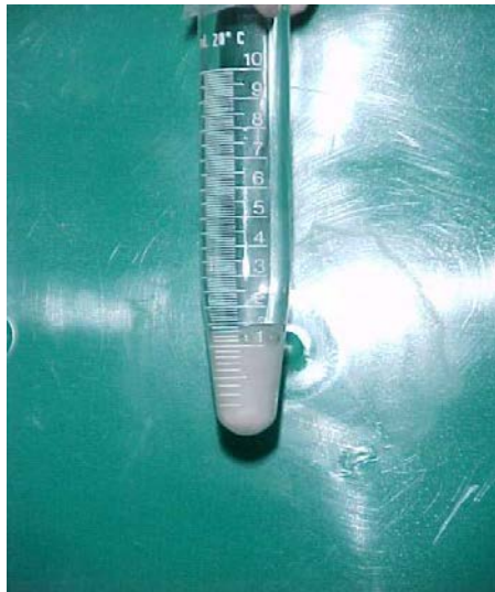
Figura 3. Tubo colector graduado para medir el volumen.
