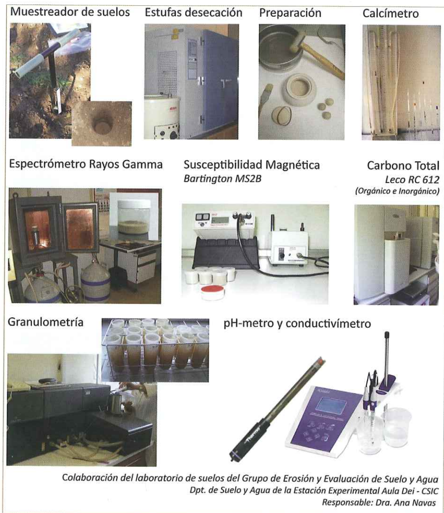
Figura 27. Muestreador de suelos, preparación de las muestras de suelo y las diferentes técnicas utilizadas en el laboratorio de suelos de la EEAD – CSIC.
