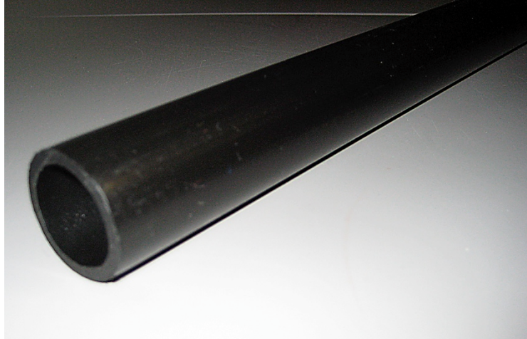
Figura 24. Pieza de tubería de polietileno grado PE100 obtenida con una combinación de los catalizadores A y C4 .
