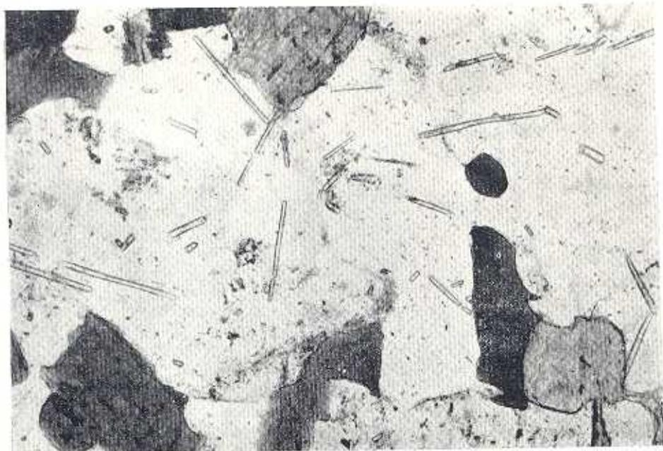
Fig. 59.—Cristales aciculares de apatito en enclave microgranular.
