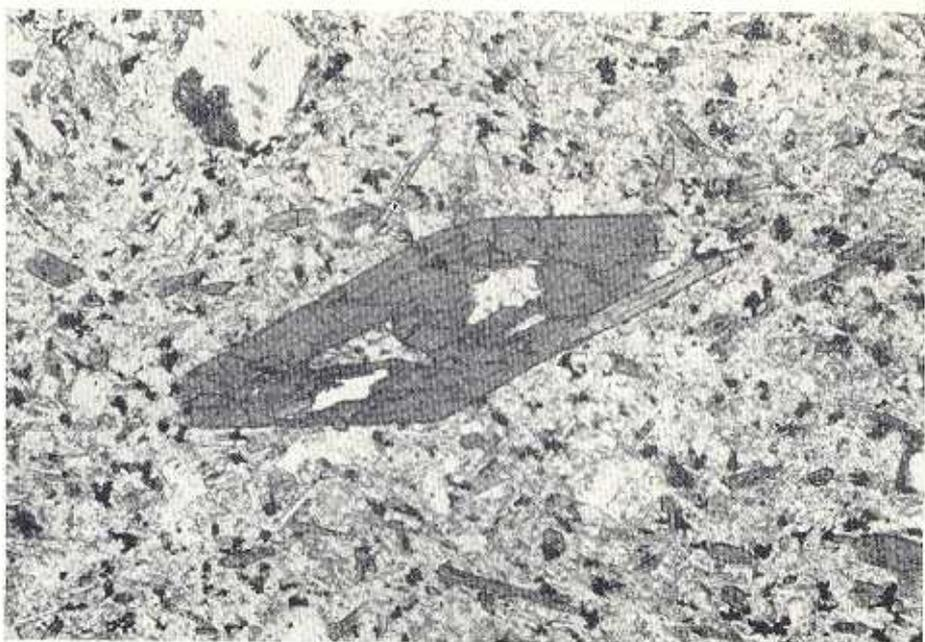
Fig. 81.—Cristal de hornblenda con corrosión central en roca lampro-
