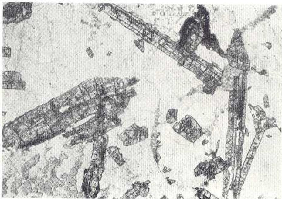
Fig. 29.—Prismas de epidota en granito cataclástico.
