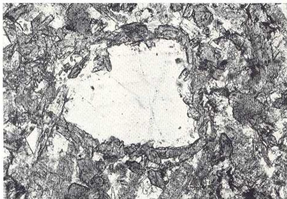
*Fig. 56.—Cristal de cuarzo rodeado de corona anfibólica en enclave microgranular. NII-X25 ILM 7332.*
