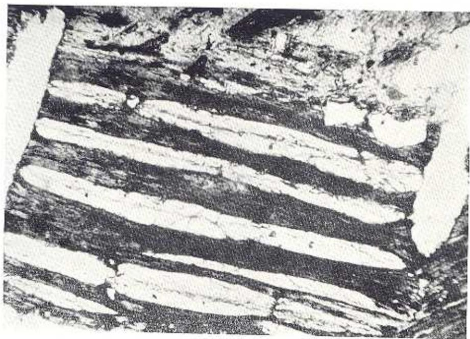
Fig. 27.—Transformación dactilítica de biotita a prehnita.
