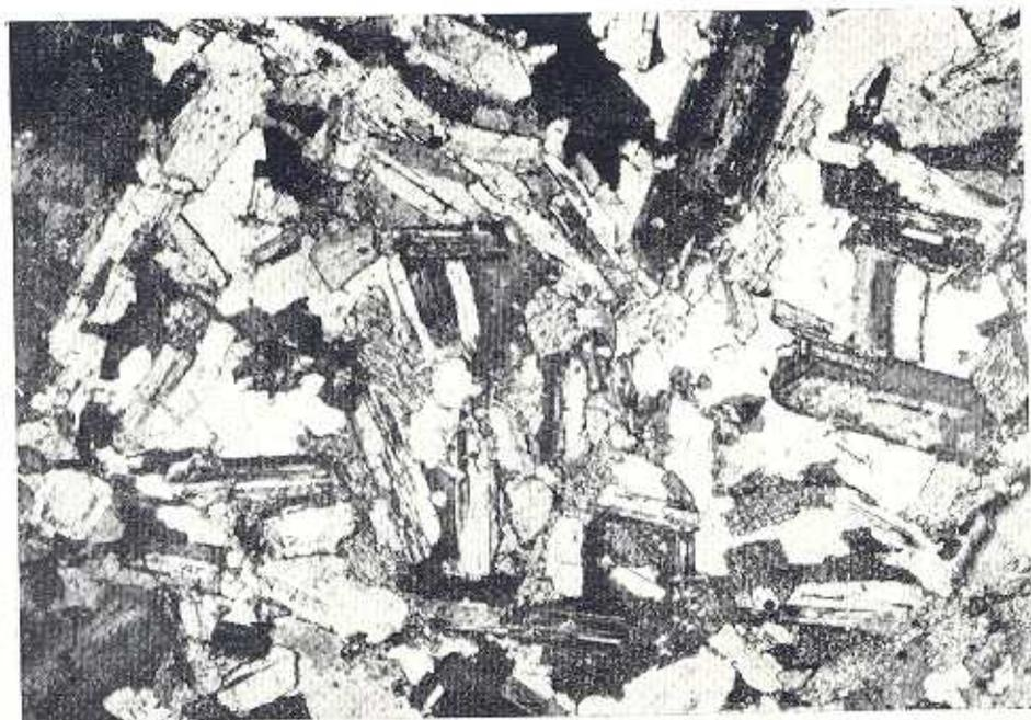
Fig. 60.—Enclave microgranular con textura diabásica.
