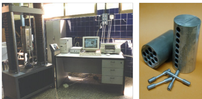
Figura 2.17 (a) Máquina de ensayos universal Servosis ME-405 (b) Imagen de las probetas de tracción mecanizadas con respecto a la dirección de extrusión de las barras AR en configuración longitudinal y transversal.
