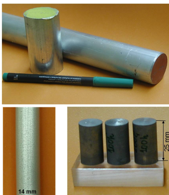
Figura 2.3. Materiales estudiados (a) Barras en estado de recepción de 38 mm de diámetro, (b) barra re-extruida en el CENIM de 14 mm de diámetro y (c) probetas cilíndricas mecanizadas de 13 mm de diámetro y 25 mm de longitud.
