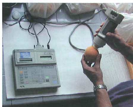
Figura 6.- Medición del color del fruto con el colorímetro Minolta CR-200.
