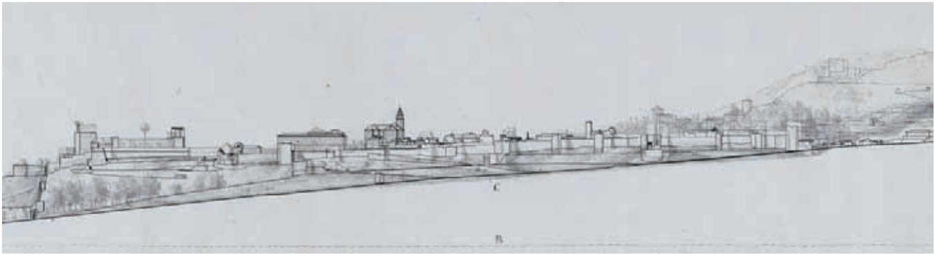
Fig. 12. Sovrapposizione del prospetto meridionale dell'Alhambra di Hermosilla con un moderno rilievo fotogrammetrico. Fig. 12. Superimposition of the south view of the Alhambra by Hermosilla on a modern photogrammetric survey.
