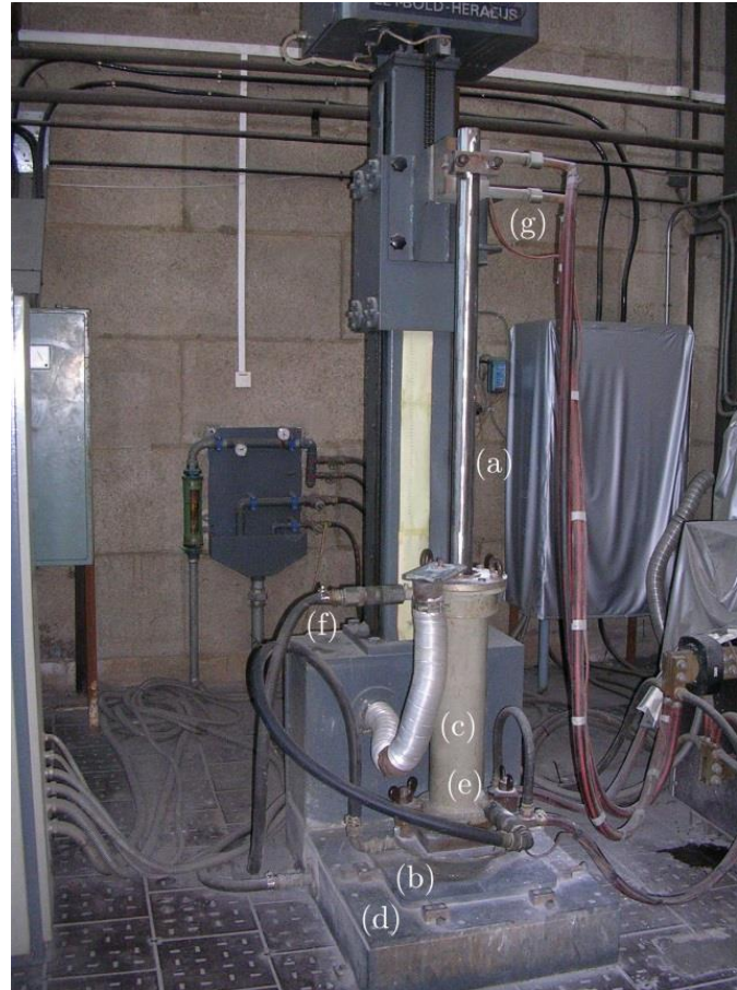
(a) Electrodo consumible. (b) placa de inicio. (c) molde refrigerado. (d) placa base refrigerada. (e) y (f) entrada y salida de circuito de refrigeración respectivamente. (g) alimentación. (h) aspecto del electrodo al finalizar la refusión y (i) baño líquido.
