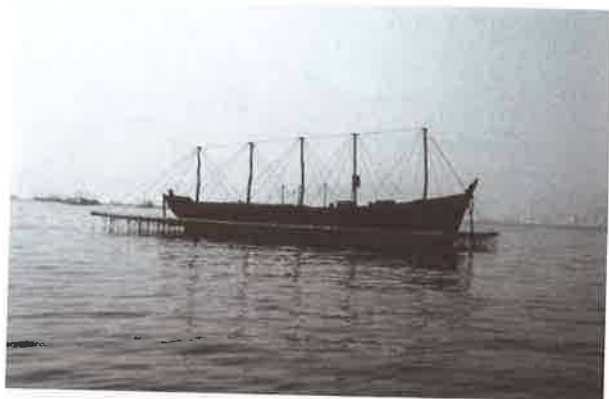
Figura II.1. Batea para cultivo de mejillón construida empleando un casco de barco viejo.
