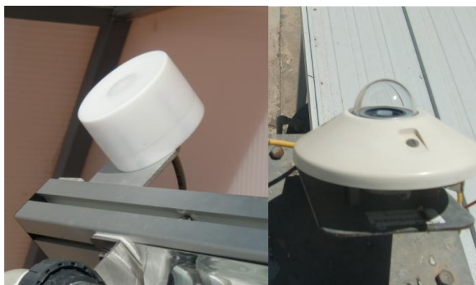
Figura 2.10 Radiómetro del fotorreactor CPC de 4.5 L (izquierda). Radiómetro de la planta piloto CPC de 32 L (derecha)
