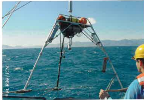
Trípode bentònic per a la monitorització del transport de sediment a prop del fons.
