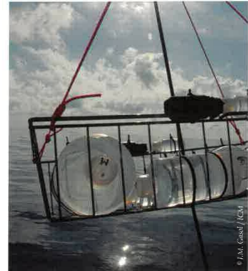
Experimento para determinar el efecto de la luz sobre el metabolismo de los microorganismos con botellas de distinta transparencia.
