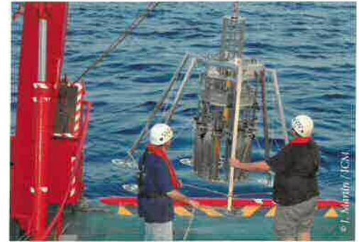
Subida a bordo del multicorer, un equipo utilizado para el estudio de los sedimentos y flujos de partículas.
