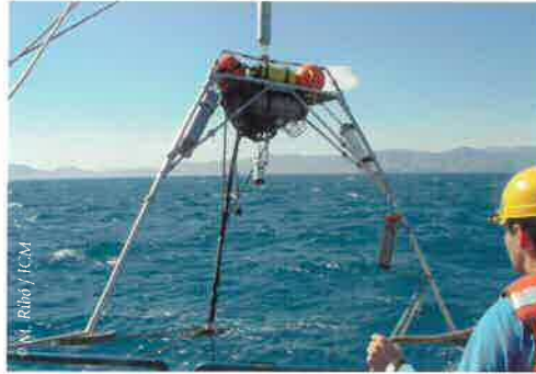
Trípode bentónico para la monitorización del transporte de sedimento en las proximidades del fondo marino.
