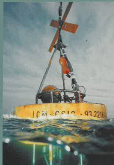
Boya diseñada en el ICM para poder medir la temperatura y salinidad del mar muy cerca de la superficie, utilizando un sensor de gran precisión y fiabilidad. Los datos, transmitidos por radio, permiten hacer un seguimiento de la evolución de las condiciones de la capa superficial en una zona sometida a variaciones a escalas distintas, desde pocos minutos hasta meses (Foto: M. Moll, EMS Sistemas de Monitorización Ambiental S.L.).
