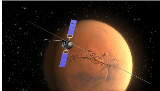
Figura 1. Imagen de la sonda Mars Express donde se aprecian las dos antenas de 20 metros que constituyen el radar MARSIS.
