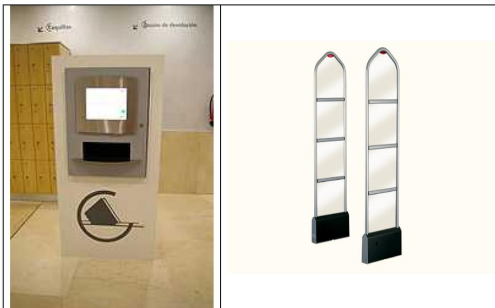
Figura 6. Estación de autopréstamo y puertas antihurto.
