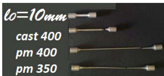
Figura 4.33. Muestras de tracción GZ61 ensayadas a 400 °C: inicial, colada y extruida a 400 °C con un 209 % de alargamiento a rotura, PM extruida a 350 °C con un 570 % y PM extruida a 400 °C con un 679%.
