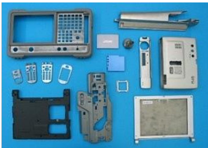
Figura 1.5. Carcasas de dispositivos electrónicos fabricados con aleaciones de magnesio mediante inyección a alta presión.
