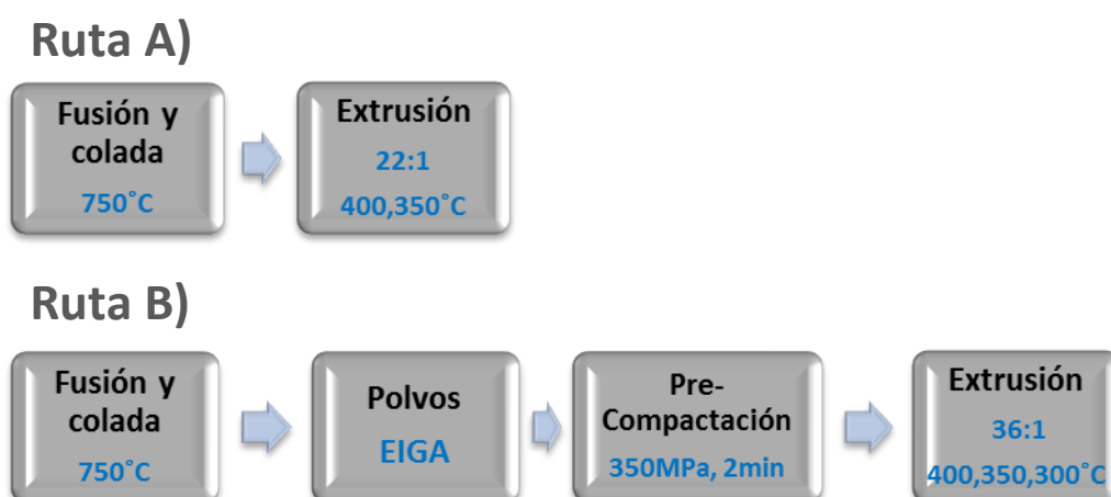
Figura 3.1. Esquema de rutas de obtención de los materiales: Ruta A) convencional y Ruta B) pulvimetalúrgica.
