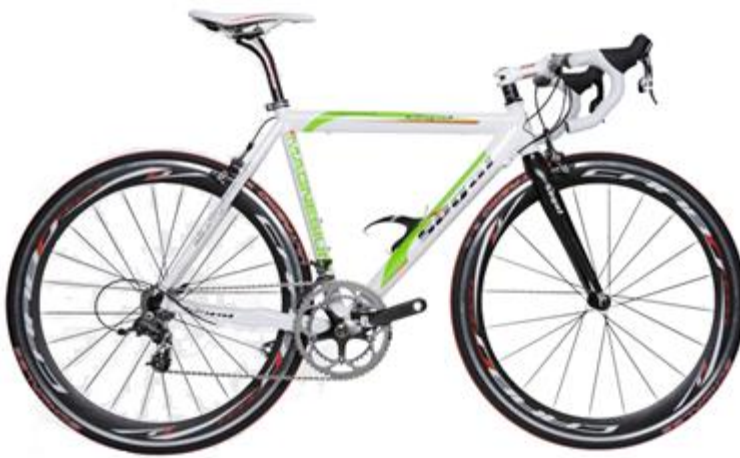
Figura 1.4. Cuadro de bicicleta de aleación de magnesio.
