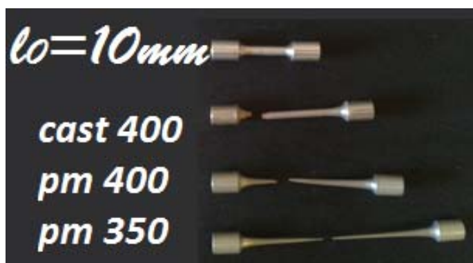
Figura 4.30. Muestras de tracción WZ31 ensayadas a 400 ^{\circ}\text{C} : inicial, colada y extruida a 400 ^{\circ}\text{C} con un 129 % de alargamiento a rotura, pulvimetalúrgica extruida a 400 ^{\circ}\text{C} con un 201%, y pulvimetalúrgica extruida a 350 ^{\circ}\text{C} con un 385 %.
