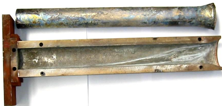
Figura 3.2. Sección de la coquilla de acero para la solidificación del caldo y barra resultante tras el proceso de colada.
