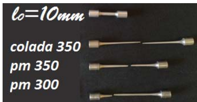
Figura 4.27. Muestras de tracción WZ21 ensayadas a 350 °C: inicial, colada y extruida a 350 °C con un 518 % de alargamiento a rotura, pulvimetalúrgica extruida a 350 °C con un 328 % y pulvimetalúrgica extruida a 300 °C con un 295 %.
