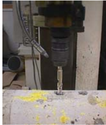
Figuras 3.29 a y 3.29 b. Extracción de muestras de los pilares mediante el taladro.
