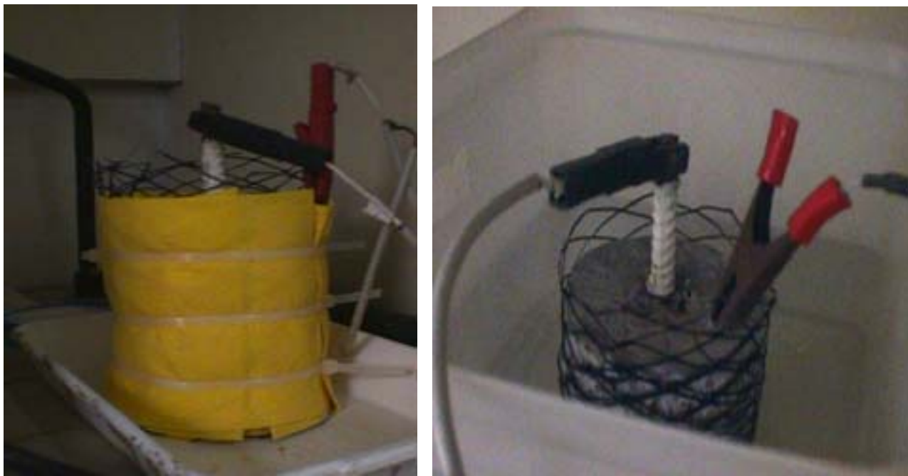
Figura 3.8. Disposición de dos probetas cilíndricas durante el tratamiento de EEC
