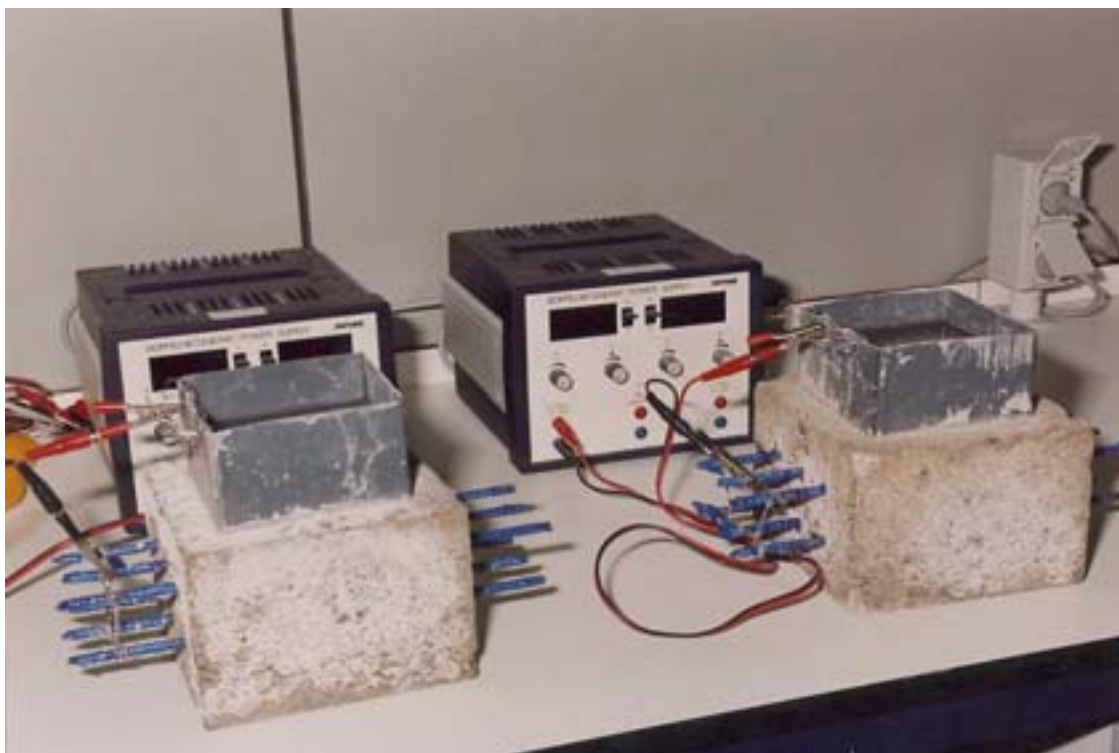
Figura 3.12 Disposición de los bloques B, C y D durante el tratamiento de la EEC
