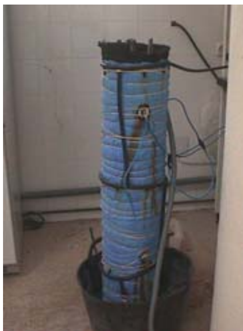
Figura 3.27.c. Columna 3 durante el tratamiento de EEC.
