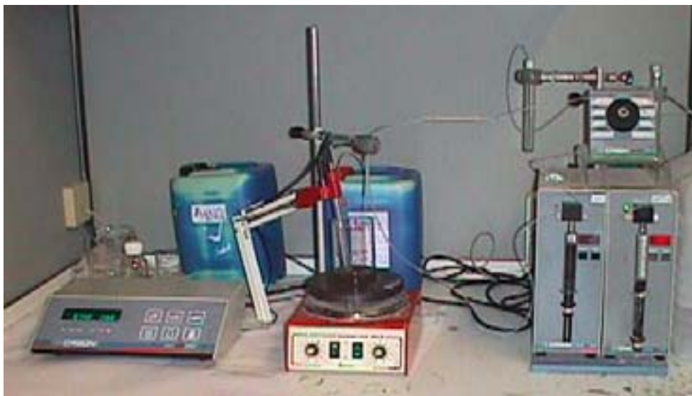
Figura 3.3. Voltímetro de precisión CRISON micropH-2002 (izquierda), agitador magnético (centro imagen) y bureta electrónica (derecha)
