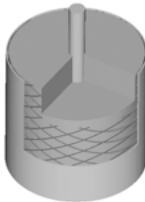
Figura 3.25. Probeta cilíndrica con ánodo de Ti-RuO_2 .
