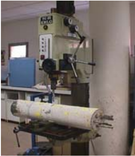
Figuras 3.29 a y 3.29 b. Extracción de muestras de los pilares mediante el taladro.
