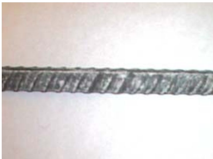
Figura 4.5.16. Barra de acero corrugado \Phi 8 B 400 S después de aplicar la técnica de EEC
