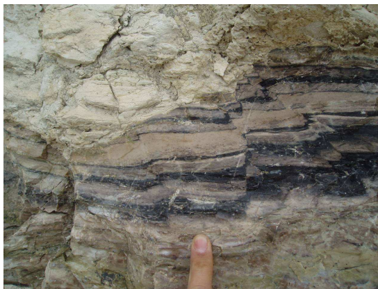
Fig. 9.12. Fotografía de diatomitas con fracturas y posteriormente silicificadas. Las láminas oscuras corresponden a niveles más ricos en materia orgánica.
