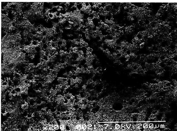
Fig. 4.- La superficie de los morteros de Baelo Claudia, colonizada por líquenes, muestra un intenso "pitting".
