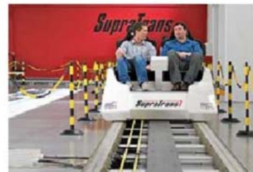
El vehículo Supratrans levita sobre imanes permanentes. EVICO GMBH/IFW DRESDEN
