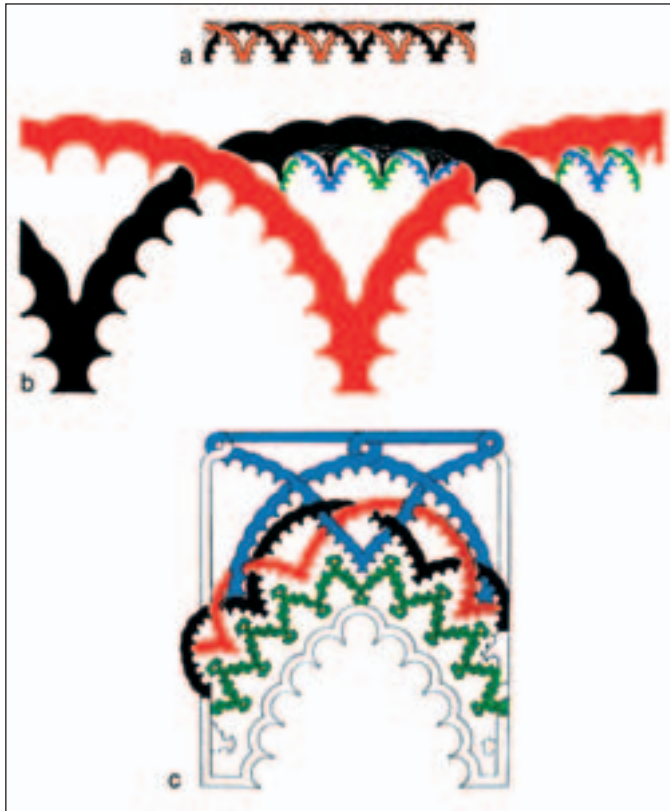
Fig. 8. a) Sistema de arcos entrecruzados dispuesto sobre el arco ciego del centro del lado norte del Salón del Trono. b) Frente septentrional del pórtico del testero norte. c) Frente meridional del ala este destacada hacia el patio del testero norte. Dibujo a del estudio de arquitectura de José Javier Aguirre, y dibujos b y c de Christian Ewert.
