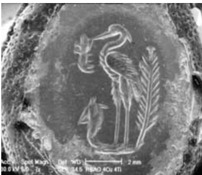
Figura 5: Micrografía MEB de la pieza estudiada: el núcleo azul (Figura 2) más compacto aparece rodeado por otra parte más porosa que corresponde a capas de óxido característico por su coloración marrón clara (Figura 2).
