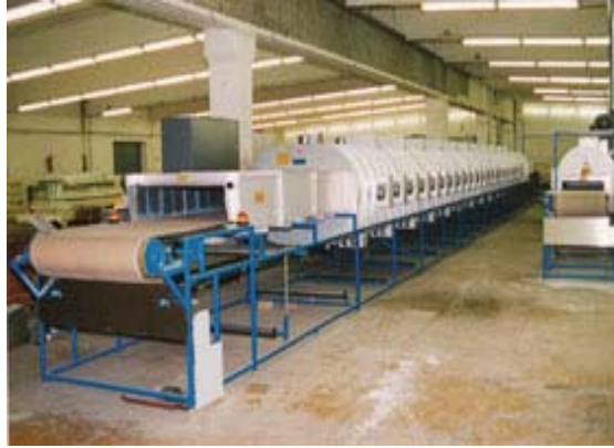
Figura 2.9 Fotografía de un dispositivo híbrido (microondas y aire caliente) empleado en la industria de la construcción [LINN HIGH THERM].
