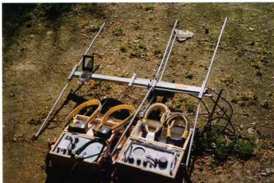
Figura 20. Material empleado en el radioseguimiento de animales salvajes.
