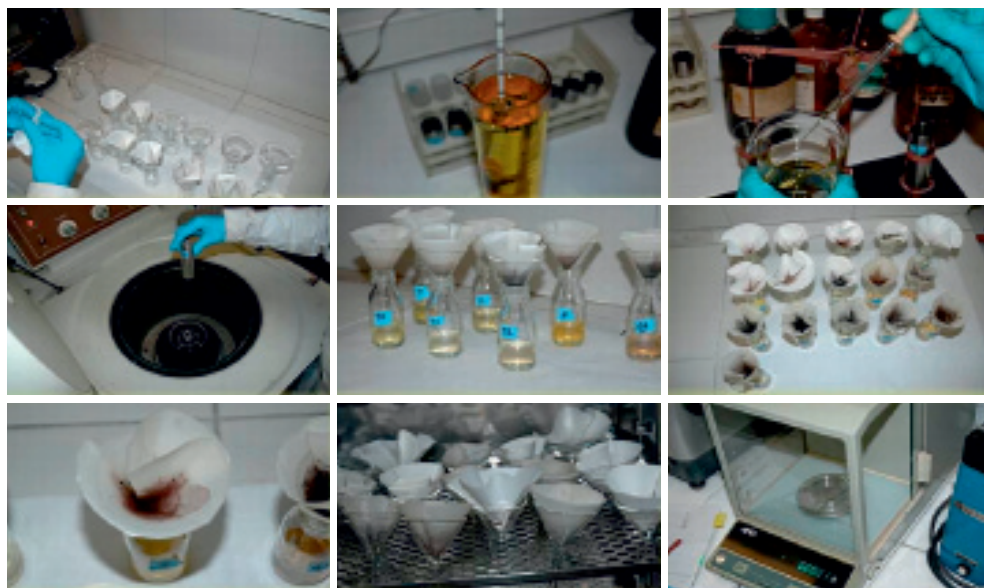
Figura 2. Separación de la materia orgánica libre de densidad inferior a 1.1. Suspensión del suelo en ácidos fosfórico 2M; tratamiento con octanol, agitación, centrifugación, separación por filtración, pesada.
