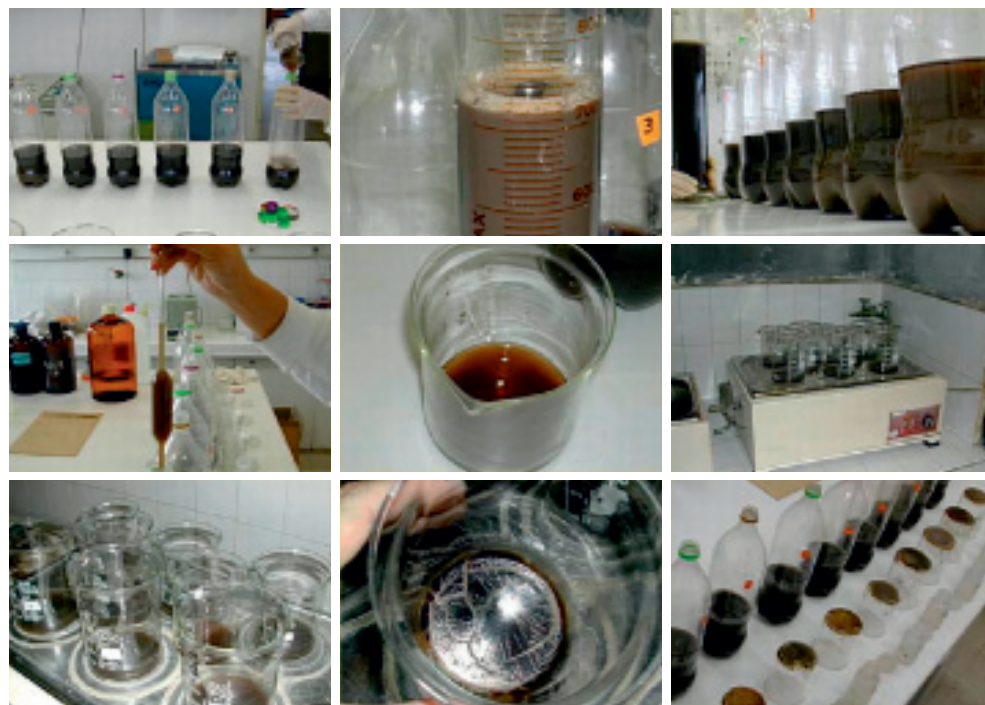
Figura 6. Extracción de SH extraíbles: Tratamiento con pirofosfato (e hidróxido sódicos 0.1M). Agitación, equilibrado de tubos y centrifugación. Separación del extracto y el residuo. Decantación de los sucesivos extractos.
