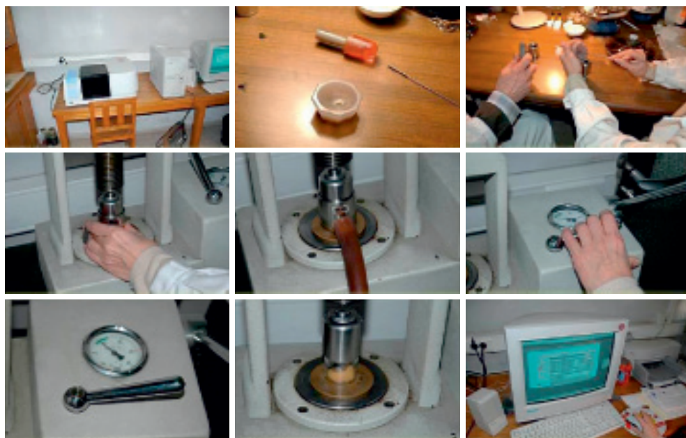
Figura 13. Preparación de pastillas de KBr para adquisición de espectros infrarrojos: homogeneización de muestra; prensa de la muestra con KBr al vacío; extracción de las pastillas y adquisición del espectro.
