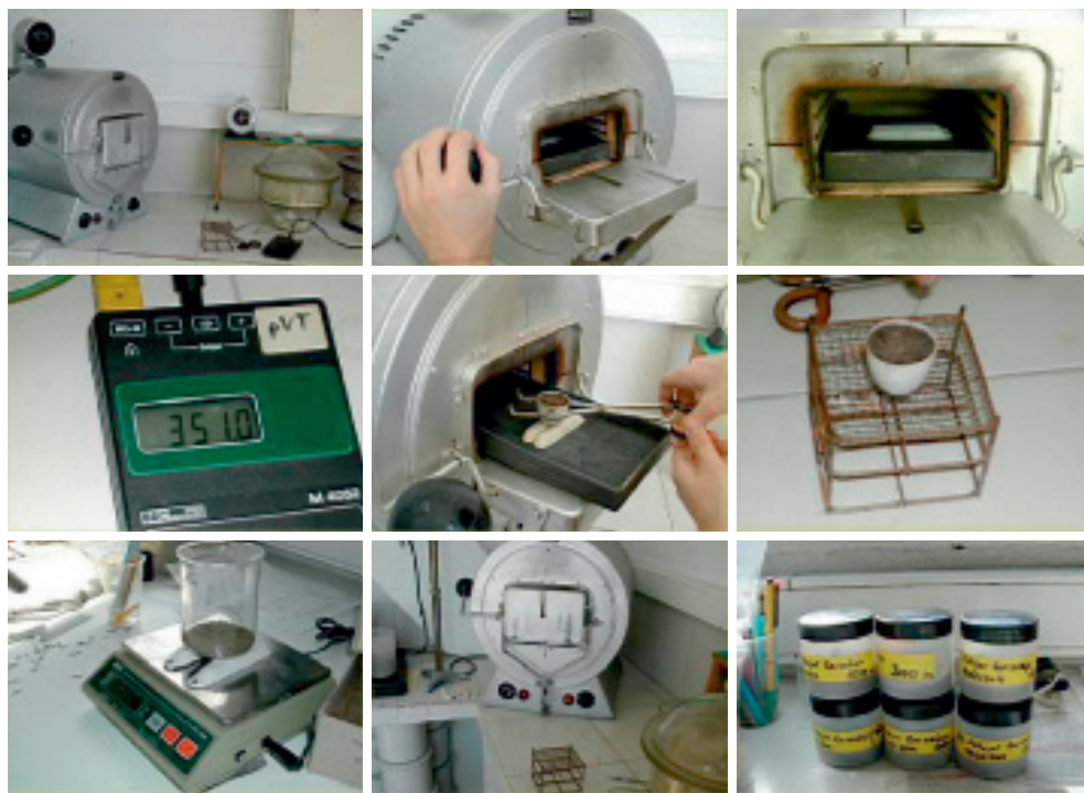
Figura 16. Experimento de calentamiento en horno eléctrico de muestras de suelo (temperatura constante a 350 °C, tiempo variable) para estudiar cambios en la composición de lípidos.
