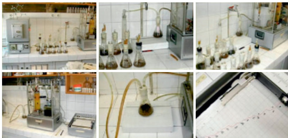
Figura 11. Incubación de muestras para actividad biológica. Preparación de matraces y ajuste de humedad; analizador de gas (por conductividad eléctrica); matraz con muestra de suelo durante la medición; registro de actividad de diferentes muestras.
