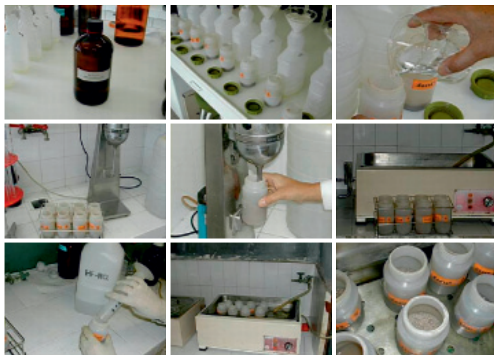
Figura 10. Desmineralización del residuo de extracción del suelo para la liberación y determinación de la humina extraíble: Tratamiento con ditionito sódico; homogeneización y reacción al baño de agua; tratamiento posterior con ácidos desmineralizantes (HF, HCl).
