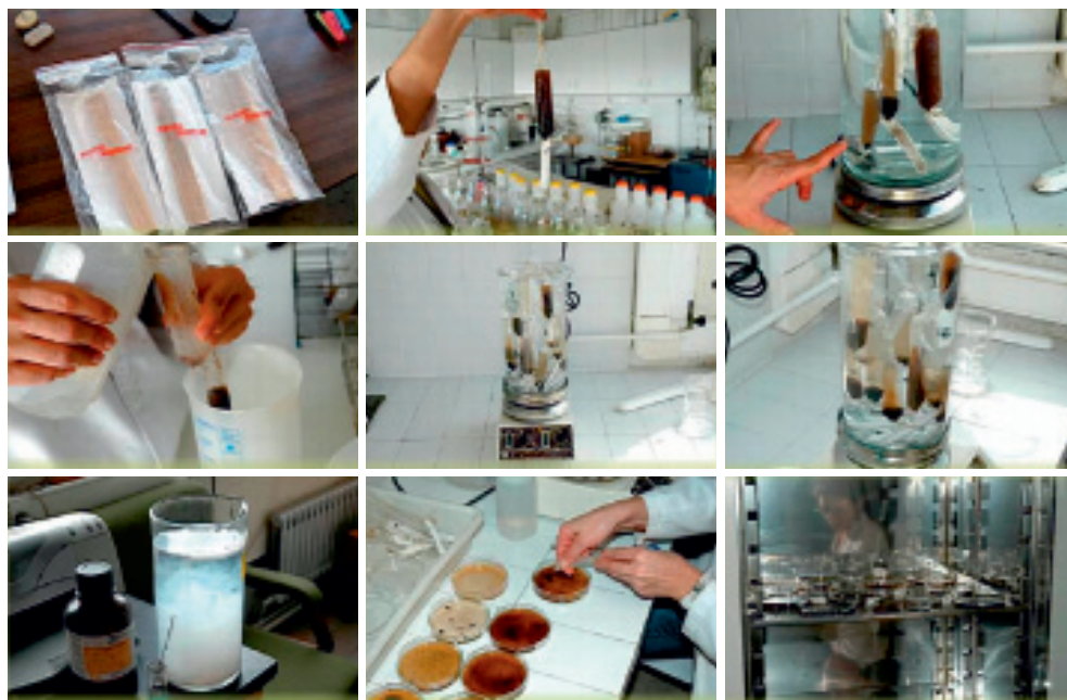
Figura 9. Diálisis de ácidos húmicos para eliminación de impurezas minerales solubles: Relleno de tubos de celofán, diálisis frente a agua destilada con agitación suave; test positivo con \text{AgNO}_3 que indica que debe seguirse renovando el agua destilada; Apertura de las bolsas y del ácido húmico.
