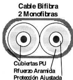
FIGURA 11. Cable de interior o de interconexión, compuesto por dos cordones monofibra paralelos.
