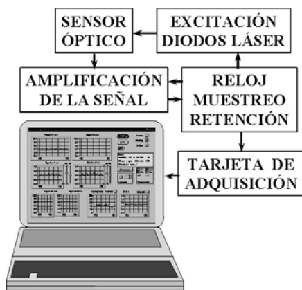
Fig.1.- Esquema del sistema de medida formado por el sensor óptico, la electrónica del sensor, la tarjeta de adquisición, el ordenador personal y los programas de procesamiento.
