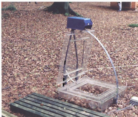
Cámara de medición de emisión de gases del suelo (Fotografía: A. Merino).
