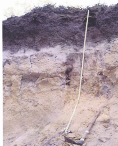
Figura 3.4. (a) Los horizontes del suelo contienen muy diferentes cantidades de carbono orgánico. Consecuentemente, la estimación del contenido de carbono orgánico total edáfico debe realizarse sumando los contenidos de carbono de cada uno de los horizontes. En el caso de que se desee conocer el carbono total acumulado, además, deberá sumarse el carbono que esté en forma de carbonatos (cuando el pH edáfico sea de neutro a básico). (Fotografía: A. Merino) y (b) Toma de muestras de mantillo en un ecosistema forestal (fotografía: F. Solla).
