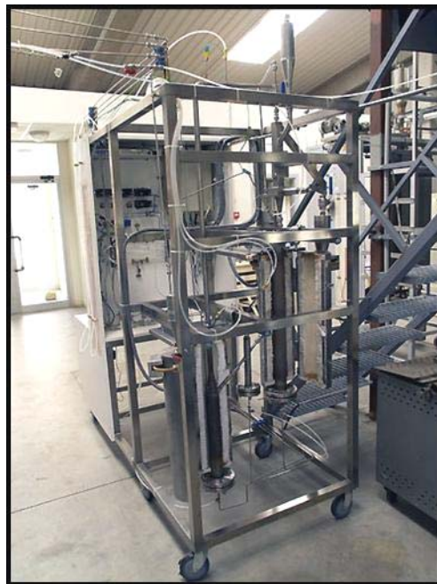
Figura 2.9. Fotografía de la Planta Piloto de CLC de 500 W_t en continuo (sin aislamiento).
