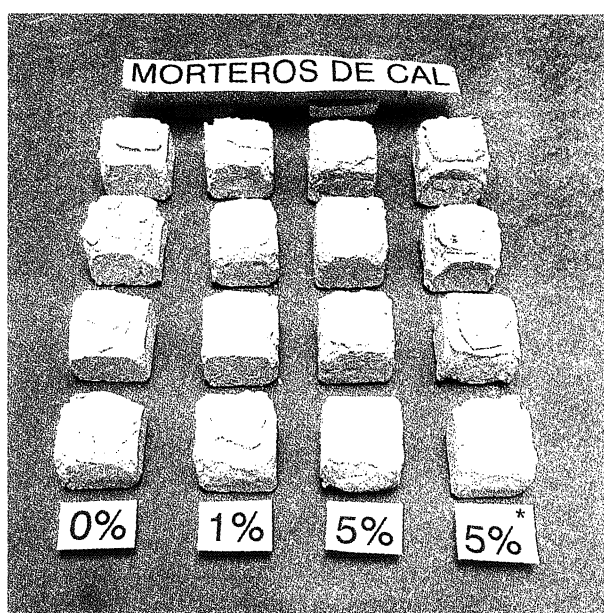
Foto 4.- Morteros de cal con 0%, 1%, 5% de sepiolita y 5%* (sepiolita+ \text{Cl}_3\text{C}_6\text{OH} ) sometidos a 10 ciclos en medio \text{Na}_2\text{SO}_4 .
