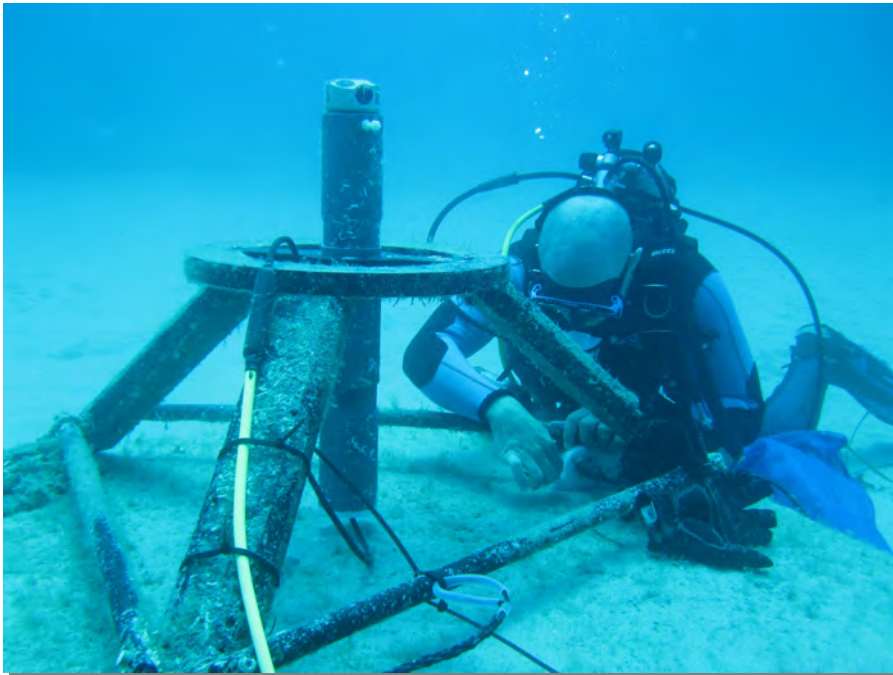
Foto 8: El correntímetro colocado en su trípode. Mientras el buceador fija el CTD SBE37
