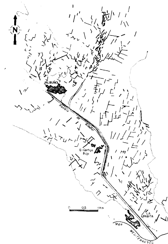
Figura 4.—Esquema de parte de las fracturas localizadas por fotointerpretación y de los tramos de ríos controlados por fracturas. En línea gruesa se señalan las fracturas consideradas seguras o muy probables. En fina los tramos de ríos presuntamente controlados por fracturas.
