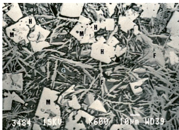
Figura 11. Microestructura de una muestra de sinterizado fabricado en el ensayo 6, con presencia de fases muy entremezcladas (x600). H = hematita; M = magnetita; F = red de ferritos aciculares y columnares; G = ganga. Presencia de poros (negro).
