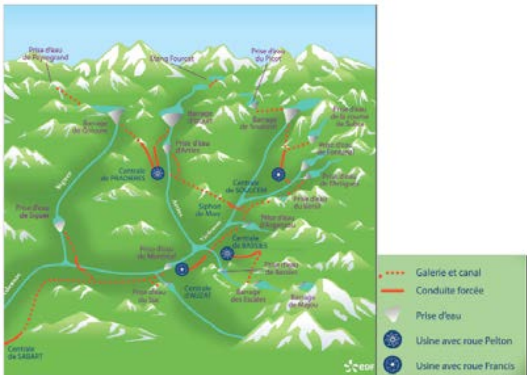
Figura 8.4: Sistema hidroeléctrico de Auzat. (Fuente: EDF, 2019).
