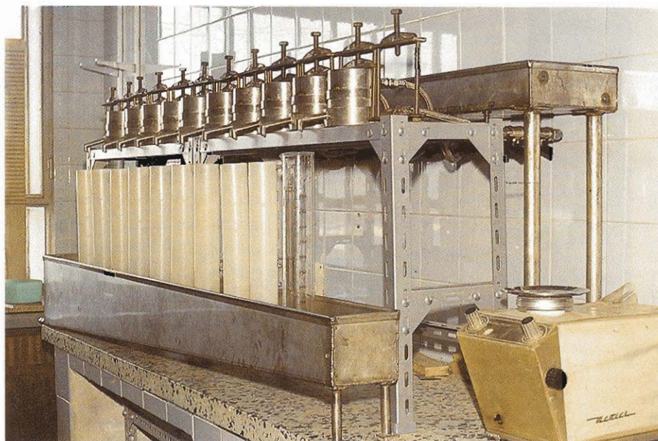
FIG. 7. Permeámetro de nivel constante para 12 muestras. La permeabilidad hidráulica de muestras de suelo con estructura no alterada se determina con un dispositivo como el de la fotografía. El agua que proviene de un depósito con nivel constante atraviesa la muestra de suelo del cilindro, y es recogida y medida durante tiempos convenientes; el valor «Q» y los de las constantes del dispositivo son los que se utilizan para el cálculo de la permeabilidad hidráulica de la muestra saturada (K), por aplicación de la Ley de Darcy, siendo L la altura de la muestra. S su superficie y h la carga hidráulica (diferencia entre el nivel constante de agua sobre la muestra y el de salida de agua después de atravesarla). Se trata de un parámetro de gran interés para el conocimiento de los suelos y para uso del agua, por ejemplo en regadío, ya que viene a significar la velocidad de infiltración del agua en régimen saturado.
