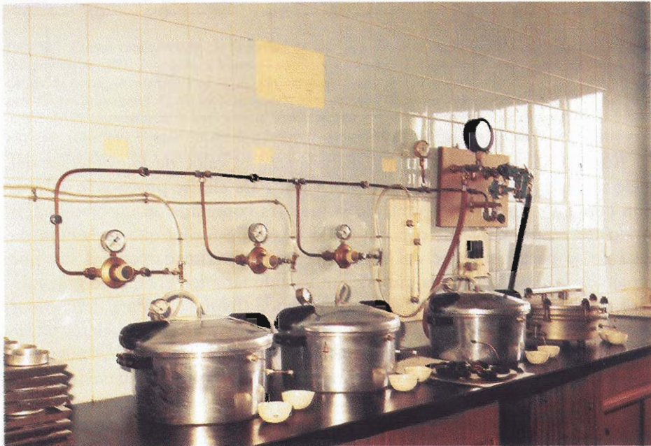
FIG. 16. Equipo de cámaras de presión según Richard para la determinación de cuatro «puntos» en la curva característica de humedad: en primer término figura una de las placas cerámicas porosas utilizadas, con los anillos de goma portamuestras de suelo.
