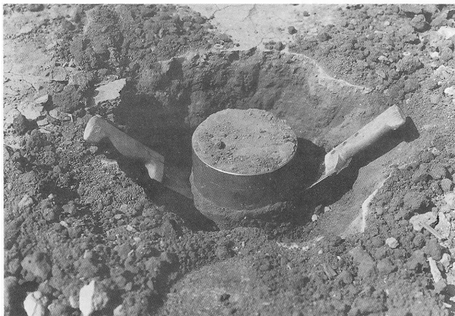
FIG. 6. Para obtener muestras de suelo sin alterar su estructura se utiliza un cilindro metálico de dimensiones normalizadas y con el borde inferior biselado. Sobre la muestra se determina la densidad aparente y la permeabilidad hidráulica.
