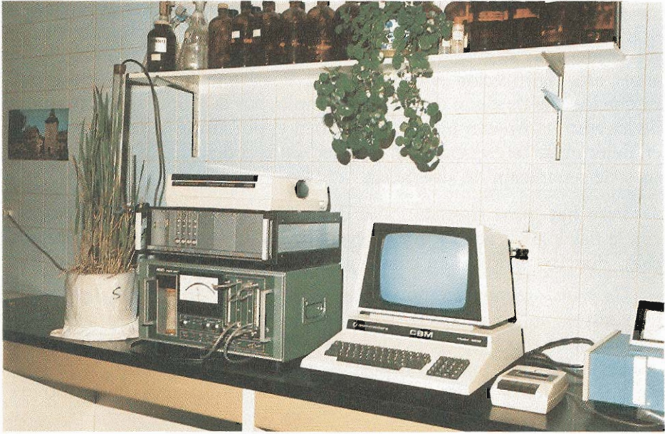
FIG. 2. Analizador de \text{CO}_2 por rayos infrarrojos. Los nuevos equipos permiten avanzar más deprisa en la investigación científica sobre la nutrición de las plantas.
