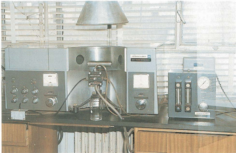
FIG. 3. Espectrofotómetro de absorción atómica. Su uso se hace imprescindible en las determinaciones de elementos minerales en la materia vegetal.
