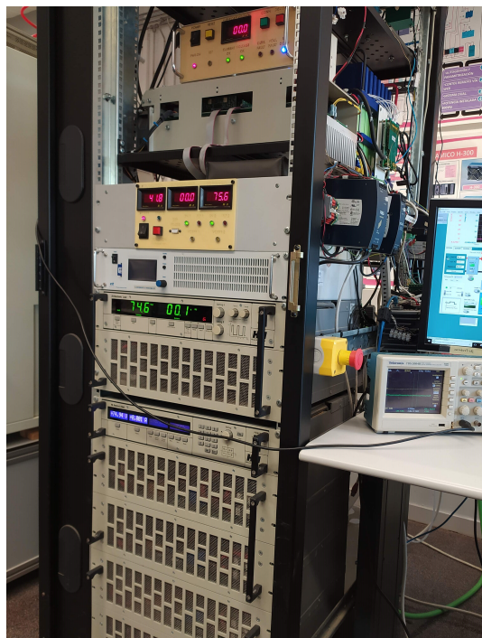
Figura 1. Plataforma experimental del sistema de generación híbrida basado en PC/SC implementado en el Institut de Robòtica i Informàtica industrial (CSIC-UPC), Barcelona, España.
