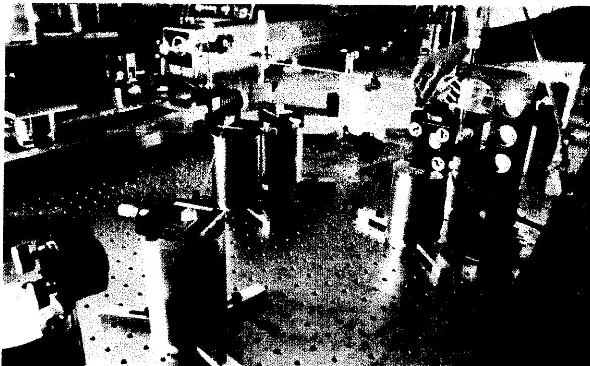
**Figura 2.6.-** Detalle del sistema de láser usado para realizar las medidas de emisión en tiempo resuelto mostrando el mode locked YAG láser y la organización del sistema de compresión de pulsos.
