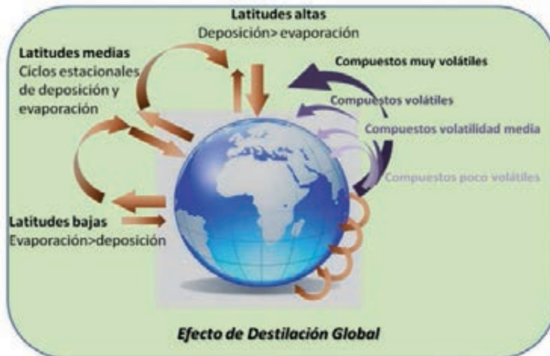
Figura 2. Representación esquemática de los procesos de transporte y distribución global de COP según el modelo de destilación global (adaptado de Wania y Mackay, 1996).
