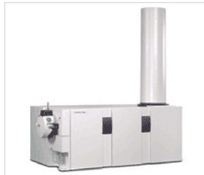
Imagen del Sistema LC-MS con analizador de tiempo de vuelo (QTOF).
