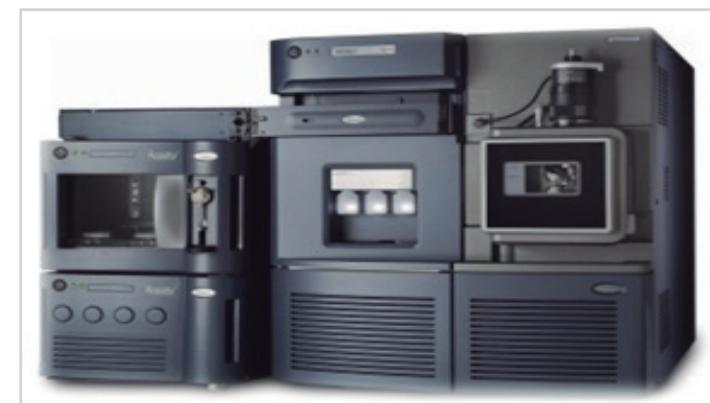
Imagen del Sistema LC-MS con analizador de tiempo de triple cuadrupolo (QqQ).
