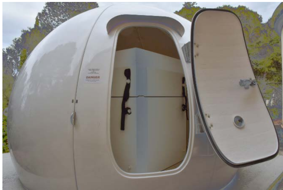
Fig. 25. Muntatge de l'iglú i de la caixa isoterma a l'OE per a la determinació de les característiques tèrmiques de l'habitacle del GyroDIF previ a l'enviament a la BAE JCI. Montaje del iglú y caja isotérmica en el OE para la determinación de las características térmicas del habitáculo del GyroDIF previo a su envío a la BAE JCI.
