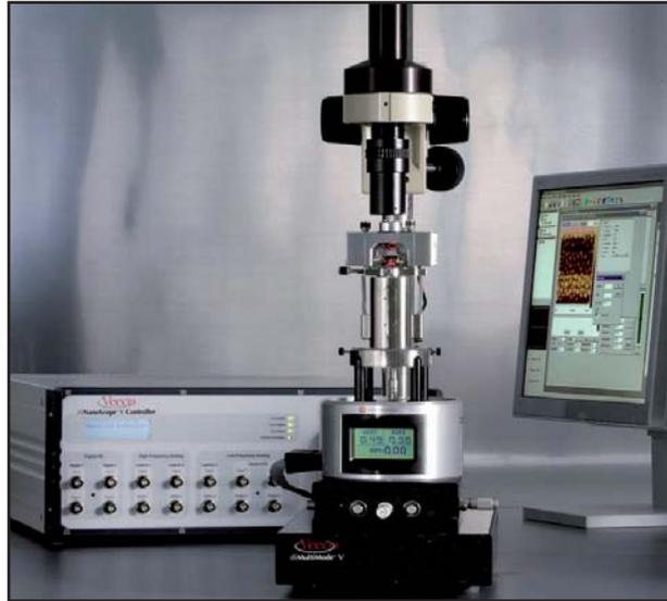
Microscopio de Fuerzas Atómicas AFM Veeco Multimode 5 Nanoscope 7.3.
